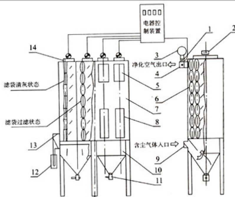
GA型布袋除尘器构造及工作原理示意图
